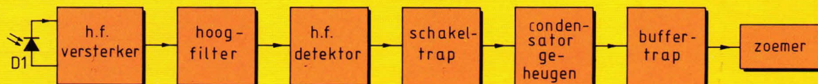
Fig. 1. Het laserdoel maakt gebruik van het feit dat de infraroodstralen worden uitgezonden met een draaggolfrequentie van ca 100 kHz.
